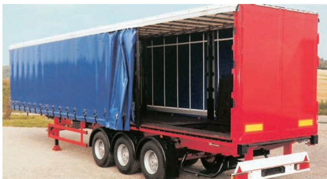
(β) Ημιρυμουλκούμενο με μεταλλικές αψίδες και συρόμενο μουςαμά.
