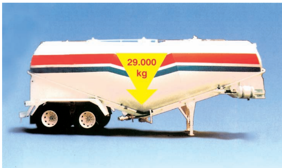
Σχ. 1.18 Μέγιστο επιτρεπόμενο βάρος διαξονικού ημιρυμουλκούμενου.
