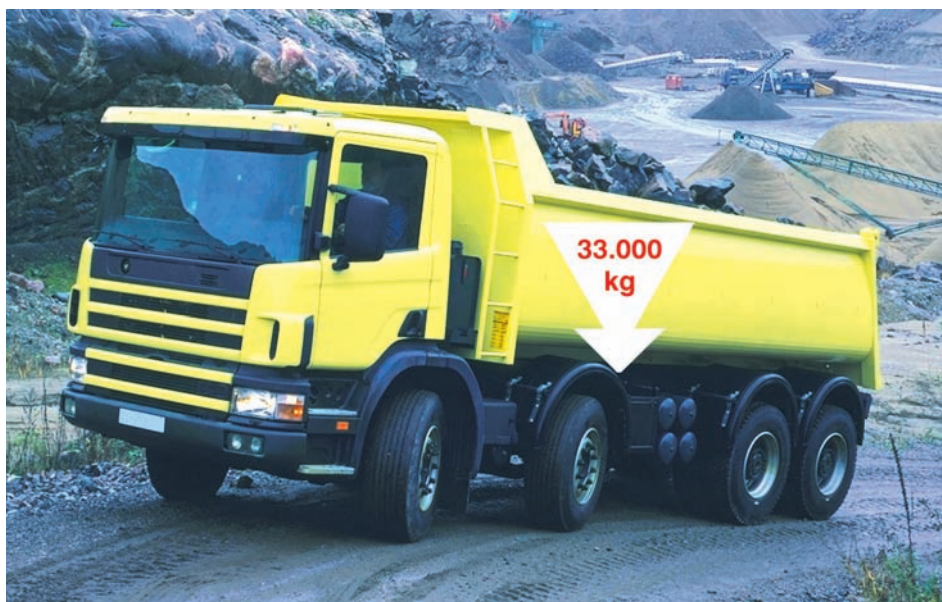
Σχ. 1.17 Μέγιστο επιτρεπόμενο βάρος τετραξονικού φορτηγού.
