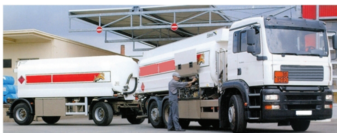
Εικ. 55 Οδικός συρμός αποτελούμενος από ρυμουλκικό βυτιοφόρο και ρυμουλκούμενο βυτιοφόρο.
