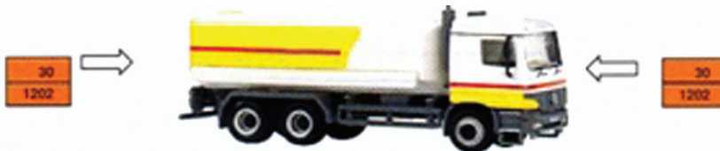
Εικ. 79 Δύο πορτοκαλί πινακίδες με τους αριθμούς αναγνώρισης (κινδύνου και ύλης), στο εμπρόσθιο και οπίσθιο μέρος της μεταφορικής μονάδας
