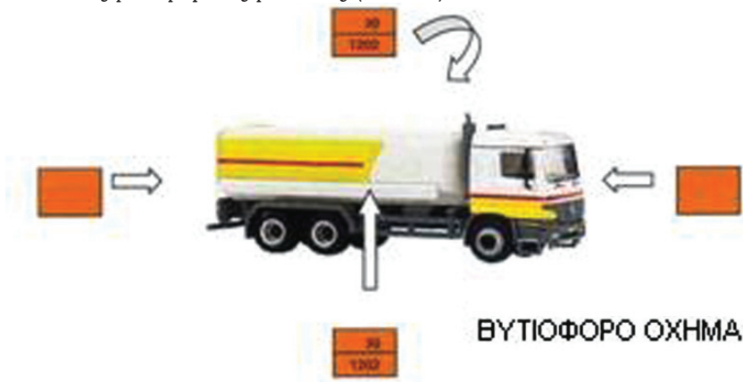
Εικ. 78. Δύο πορτοκαλί πινακίδες χωρίς αριθμούς στο εμπρόσθιο και οπίσθιο μέρος της μεταφορικής μονάδας και από μία πινακίδα με αριθμούς αναγνώρισης σε όλες τις πλευρές των βυτίων
