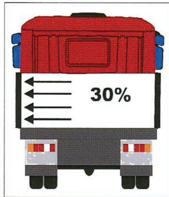
Εικ. 26 Αντοχή πλευρικών τοιχωμάτων οχήματος
