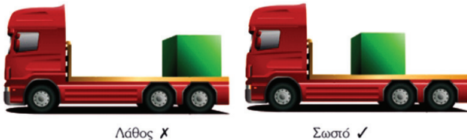
Εικ. 38 Κατά μήκος της πλατφόρμας τοποθέτηση φορτίου.
