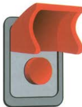
Σχήμα 2.24. Κεντρικός διακόπτης κινδύνου
